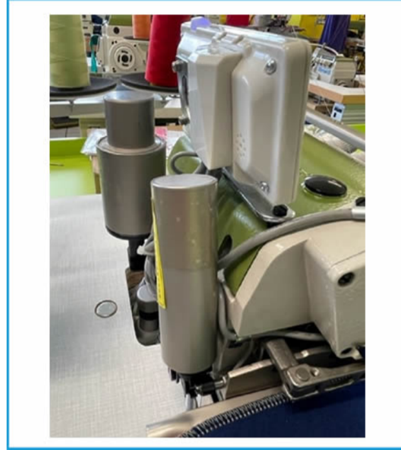
DISPOSITIVI ELETTRICI PER S852 E ALZAPIEDINO ELECTRONIC DEVICE FOR S852 AND FOOT LIFTER
