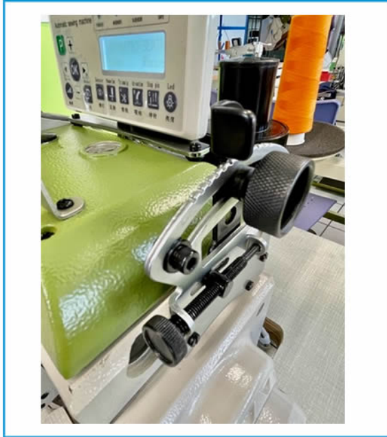
DIFFERENZIALE TRASPORTO SUPERIORE UPPER FEEDING DIFFERENTIAL
