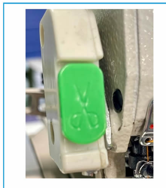
PULSANTE MANUALE DI TAGLIO (S851) MANUAL CUTTING BUTTON (S851)
