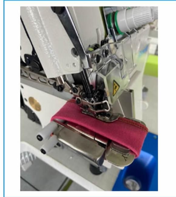
esempio di cucitura con guida regolabile samples of sewn with adjustable guide
