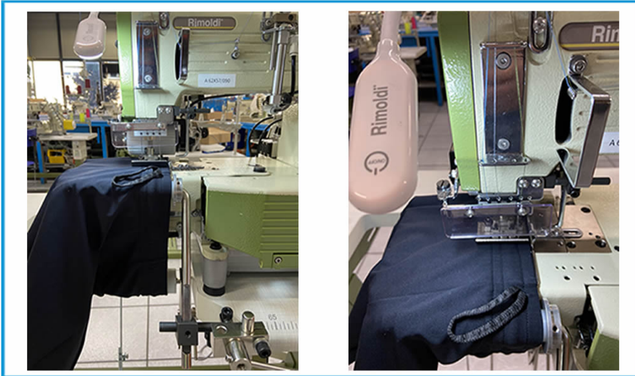
cucitura su capi tubolari sewing on tubular garments
